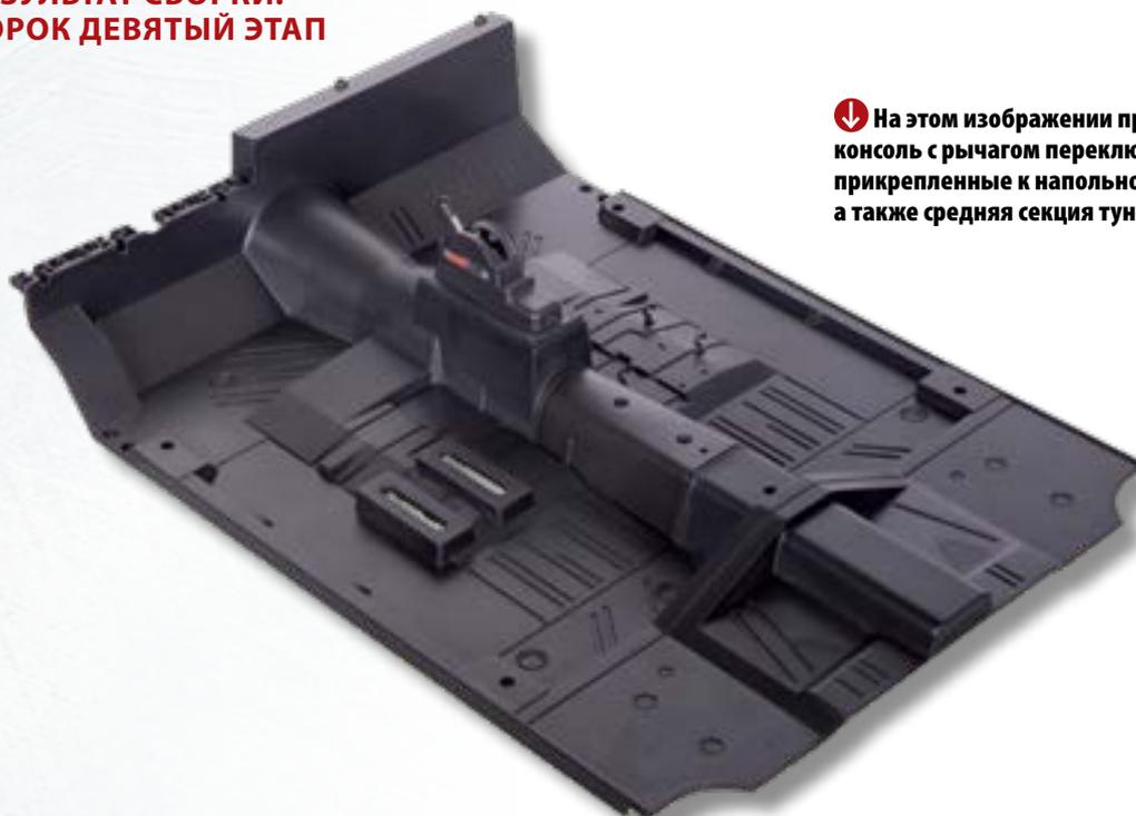
⬇ На этом изображении представлены консоль с рычагом переключения передач, прикрепленные к напольной панели салона, а также средняя секция туннеля трансмиссии.
